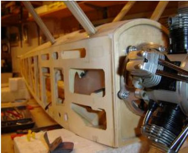
Stoppmuttern mit meinen feinen, gepflegten, ja schon fast zerbrechlich wirkenden Bürofingern hinter den Motorspant gefummelt... der Tank, welchen ich ja schon vorher schön in Moosgummi gelagert eingebaut hatte und welcher nur in Notfällen mit Trick 17 und Abschleichen demontiert werden kann, kommt nun natürlich in den Weg und immer wenn ich die Mutter fast auf dem Gewinde hatte, juckte es mich an der Nase, Claudia Schiffer kam in meine
