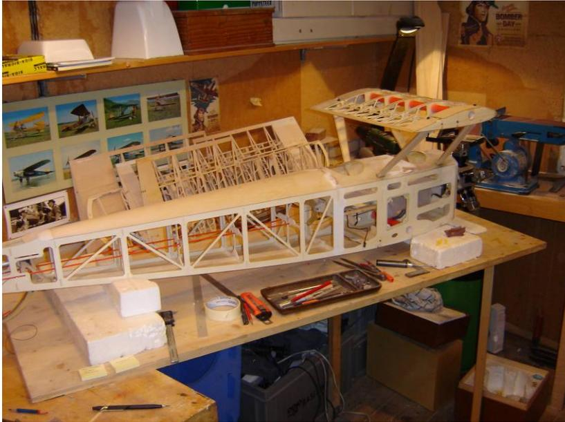
Überprüfung dessen Einstellwinkel, können dieselben in den Rumpf verleimt werden. Wenn man an dieser Stelle absolut exakt arbeitet, sollte später keine Korrektur der EWD notwendig sein. Macht man diese Arbeiten aber nicht absolut seriös, dann bekommt der Erbauer ein Modell welches nie richtig schön zu fliegen ist. Nun, ich auf meiner Seite habe zum einmessen des Tragflächen Mittelteiles je eine Hilfsleiste aus Kiefernholz
