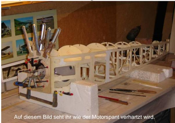
Auf diesem Bild sieht ihr wie der Motorspant verhartet wird.
