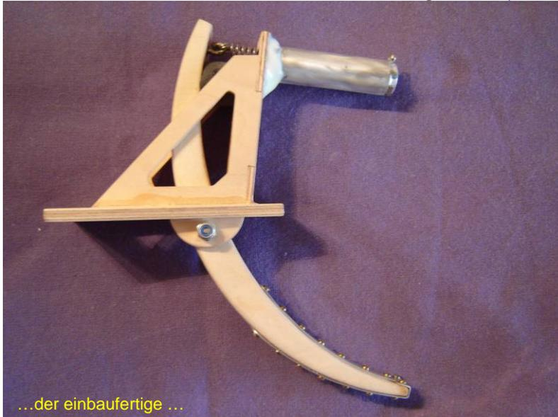
Birkesperrholz- Teilen verleimt und wird danach gemäss Plan beschliffen bis dieser durch die Ausfräsung der Spornträgerplatte passt. Der Sporn ist als eine Einheit auf einer Trägerplatte hinten auf den Rumpf in eine passende Aussparung mit zwei Schrauben befestigt und kann jederzeit gewartet werden. Ich bin mir am überlegen, ob ich eine zweite Trägerplatte anfertige, auf der ich dann ein ganz normales lenkbares Spornrad montieren kann und dieses
